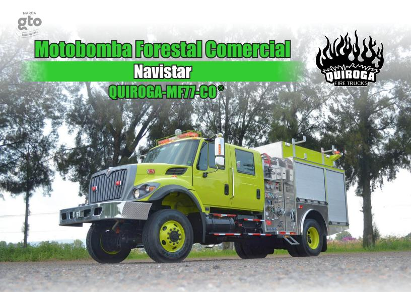
Las motobombas cumplen modelo MF/77 con los requerimientos que exige la NFPA #1901 o #1906 y están disponibles con 4 a 5 compartimientos fabricados con perfilería y placas 100% de aluminio 0.188". Los compartimientos cuentan estantes de diversos tipos, tableros para herramientas, etc. para llevar el equipo necesario para el combate de incendios forestales o de primera respuesta.
