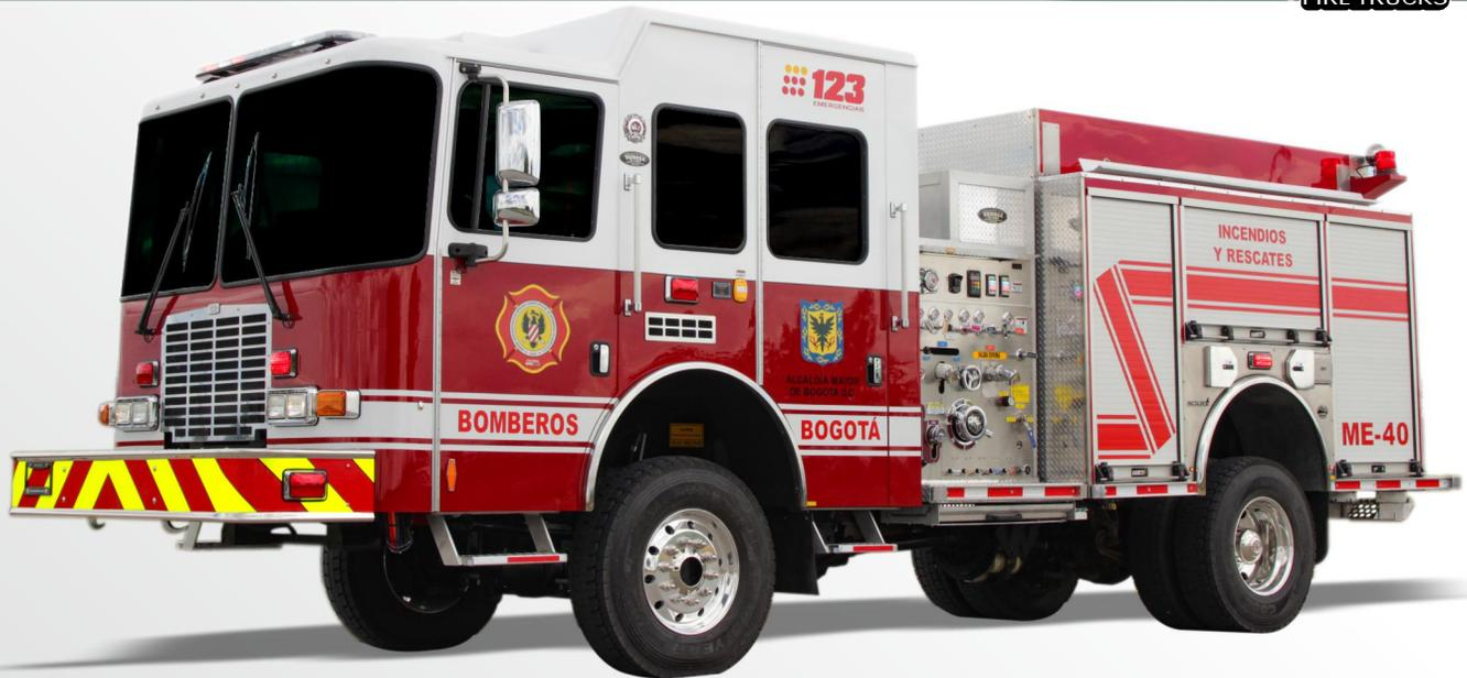
Las motobombas cumplen modelo MF/77 con los requerimientos que exige la NFPA #1901 o #1906 y están disponibles con 4 a 6 compartimientos fabricados con perfilería y placas 100% de aluminio 0.188". Los compartimientos cuentan estantes de diversos tipos, tableros para herramientas, etc. para llevar el equipo necesario para el combate de incendios forestales o de primera respuesta.
