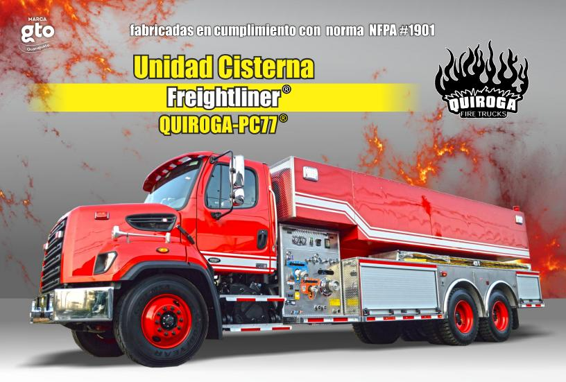
Fabricados en diferentes materiales: acero inoxidable, aluminio, polipropileno o acero. Formas "T", rectangular o elíptico, todos los tanques son fabricados con rompeolas internos de acuerdo a NFPA, Puede configurar el sistema de bombeo y descargas su medida, con bombas centrifugas mediante toma de fuerza (PTO), Eje Motriz (Split-Shaft) o motor independiente (Engine Driven).
