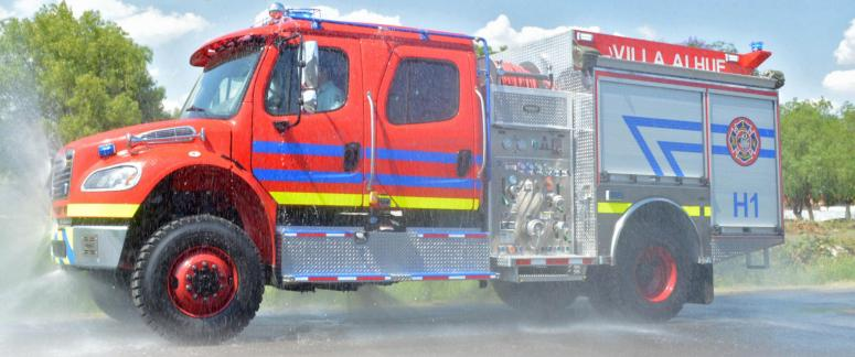
Las motobombas cumplen modelo MF/77 con los requerimientos que exige la NFPA #1901 o #1906 y están disponibles con 4 a 6 compartimientos fabricados con perfilería y placas 100% de aluminio 0.188". Los compartimientos cuentan estantes de diversos tipos, tableros para herramientas, etc. para llevar el equipo necesario para el combate de incendios forestales o de primera respuesta.
