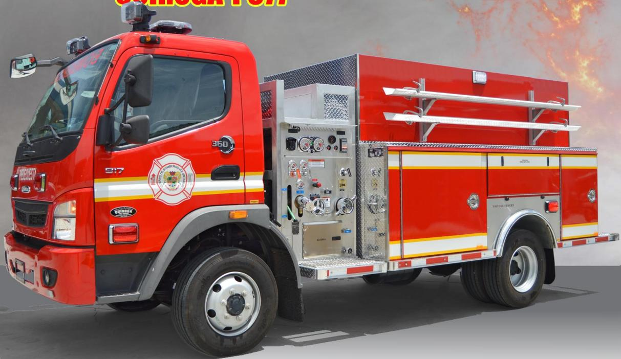
Fabricados en diferentes materiales: acero inoxidable, aluminio, polipropileno o acero. Formas "T", rectangular o elíptico, todos los tanques son fabricados con rompeolas internos de acuerdo a NFPA, Puede configurar el sistema de bombeo y descargas su medida, con bombas centrífugas mediante Eje Motriz (Split-Shaft) o motor independiente (Engine Driven).
